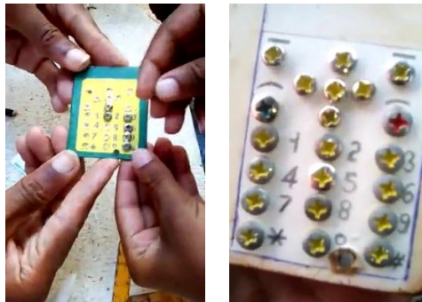
Figure 28: Les vis placés ainsi servent de touche pour composer les numéros
