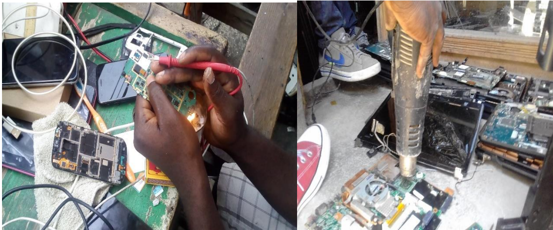
Figure 23: (à gauche) usage d'une bougie pour chauffer la carte mère d'un téléphone mobile; (à droite) usage du gond ou airgone pour chauffer la carte mère d'un PC
